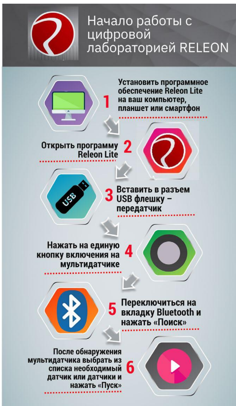
Рис. 14. Алгоритм работы с программным обеспечением Releon Lite
